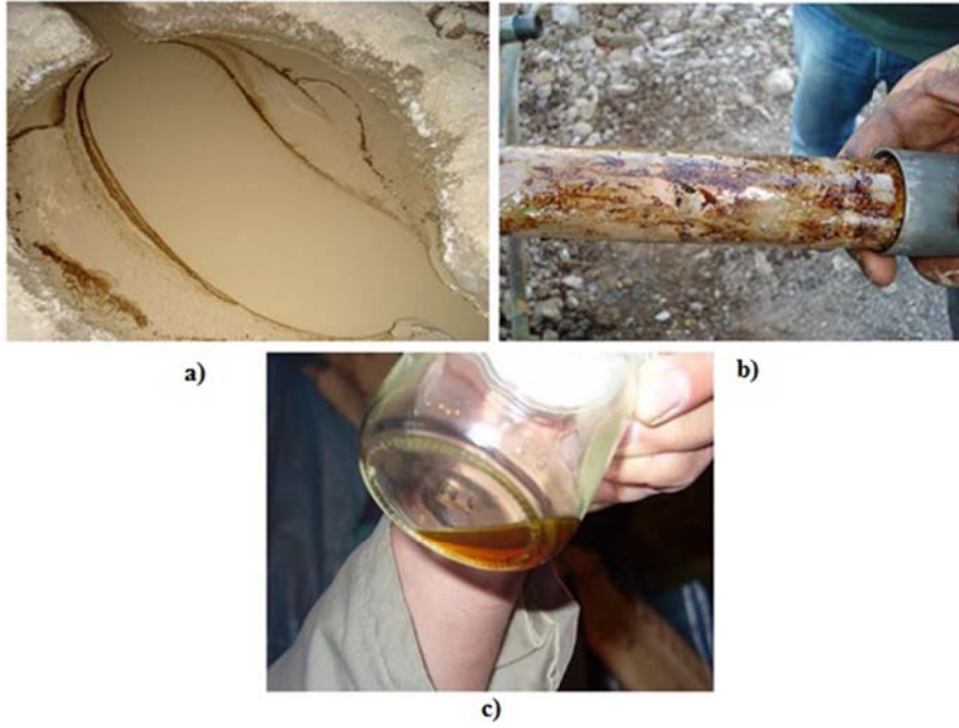
Şekil 5.35. Konya-Niğde Neojen havzasında yapılan çalışmalarda a) sondaj çamuru ile birlikte çıkan petrol, b) petrollü karot örneği, c) kimyasal eritici ile çözündürülmüş petrol
