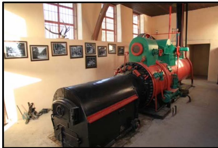
Şekil 5.27. Odundan Elektrik Üreten Jeneratör
